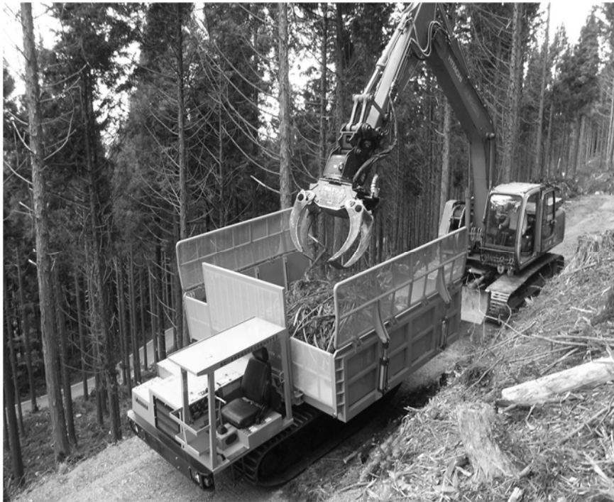
図 3.2 開発した森林バイオマス対応集材車両（運材車型）
