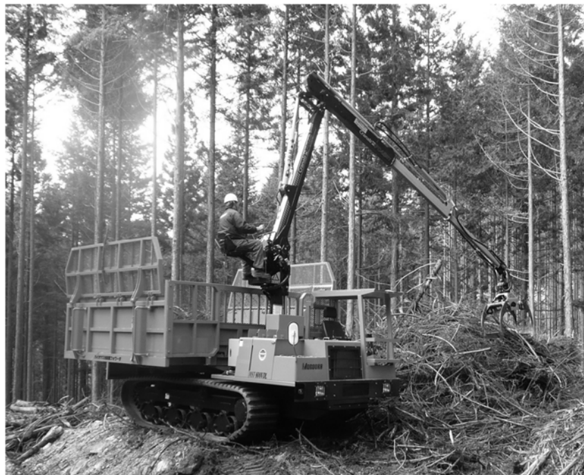
図 3.3 開発した森林バイオマス対応集材車両（フォワード型）
