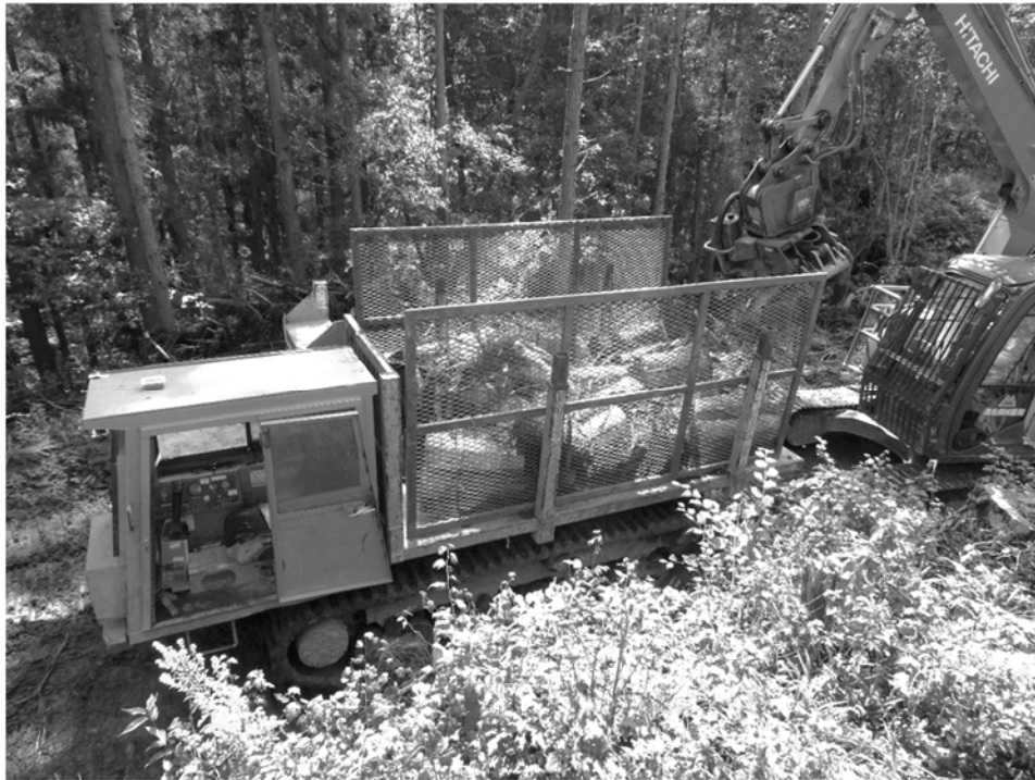
図 4.21 端材の搬出に使用した箱型車（後積機の荷台に鉄製の側壁を設置）
