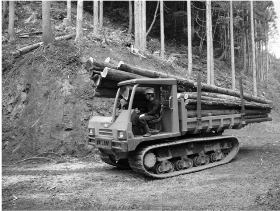
図 4.6 他積載型フォワーダへの一体材の積載状況
