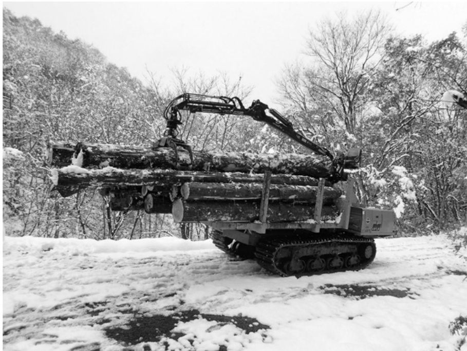
図 4.7 自積載型フォワーダへの一体材の積載状況
