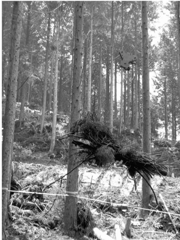
図 2.2 タワーヤードによる森林バイオマスの搬出作業状況
