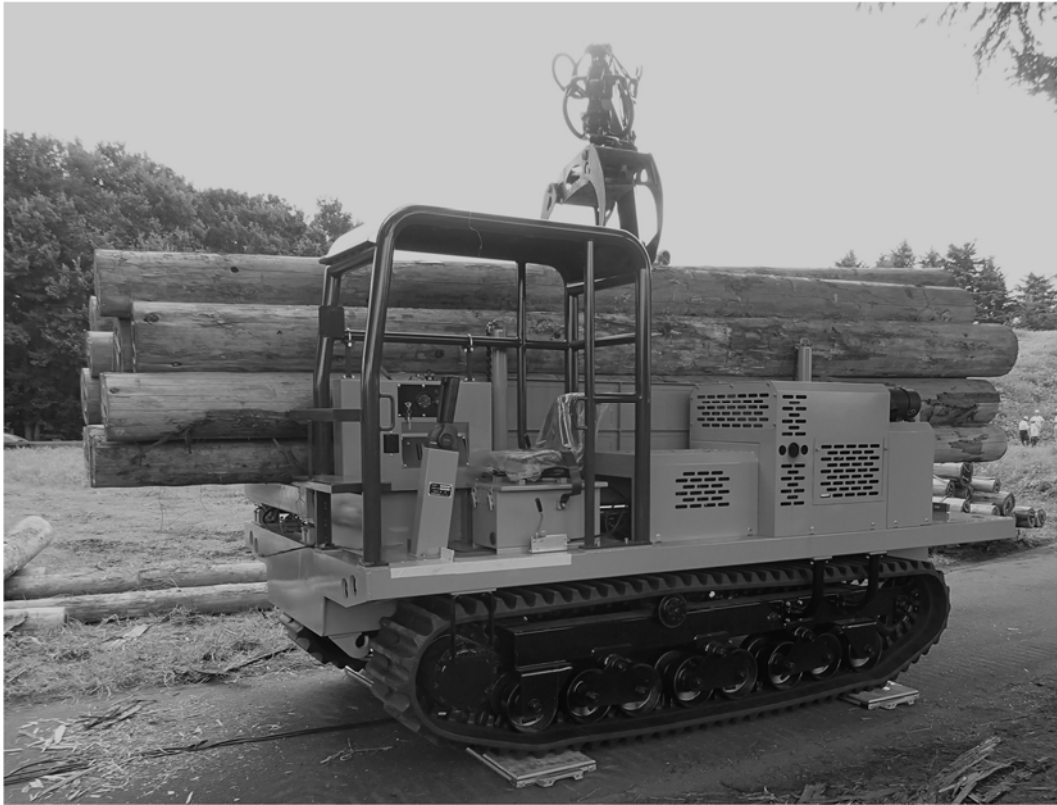
図 4.11 開発した横積式フォワーダ
