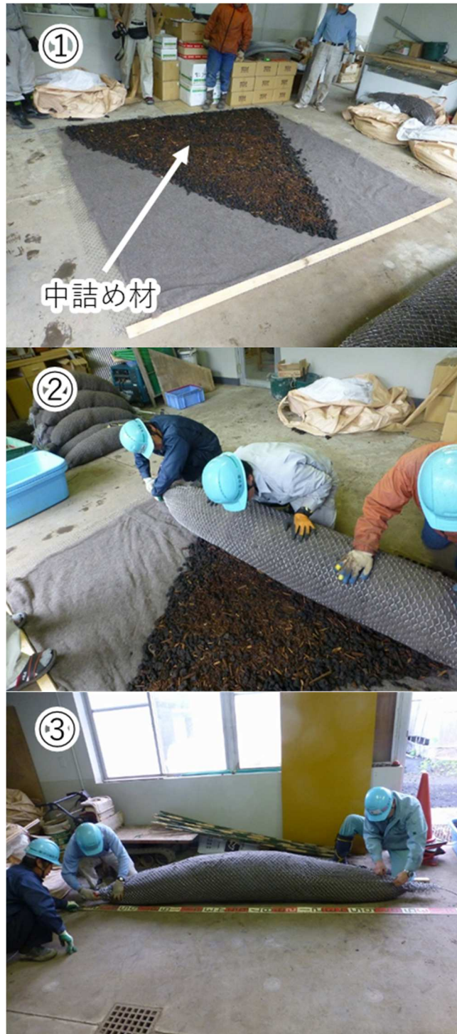
図 6-2-2 三日月型資材(弧長 3 m)の製造方法(小川, 2019;特許第 6037518 号)
