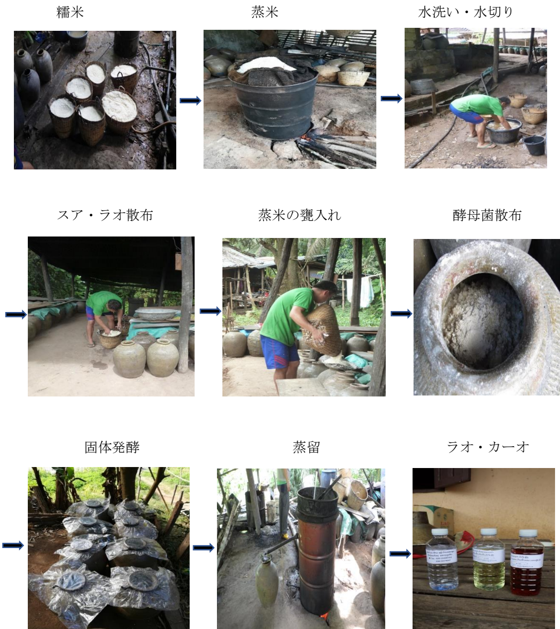
図4-4. 米蒸留酒（ラオ・カーオ）の製造工程
