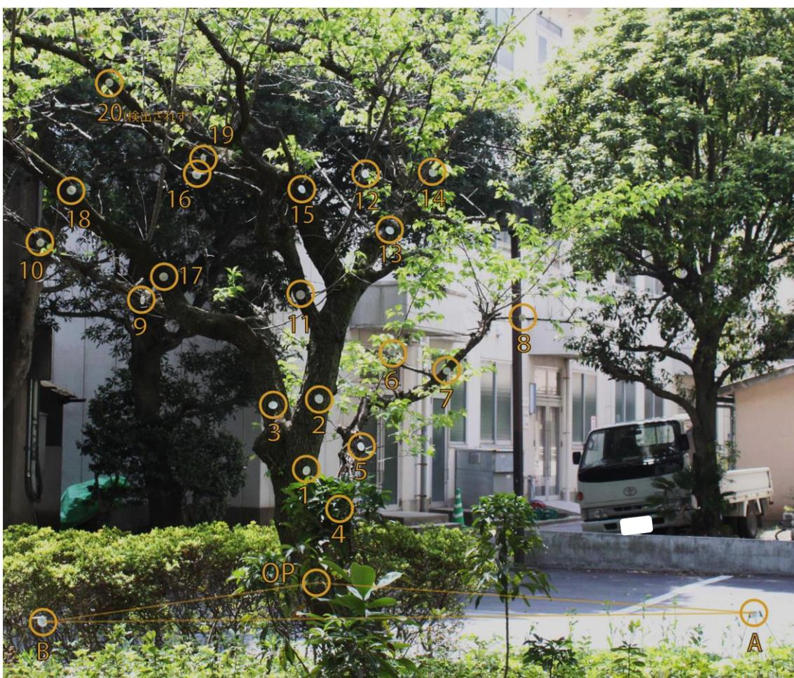
図 42 ウメに設置したターゲット（検証点）
