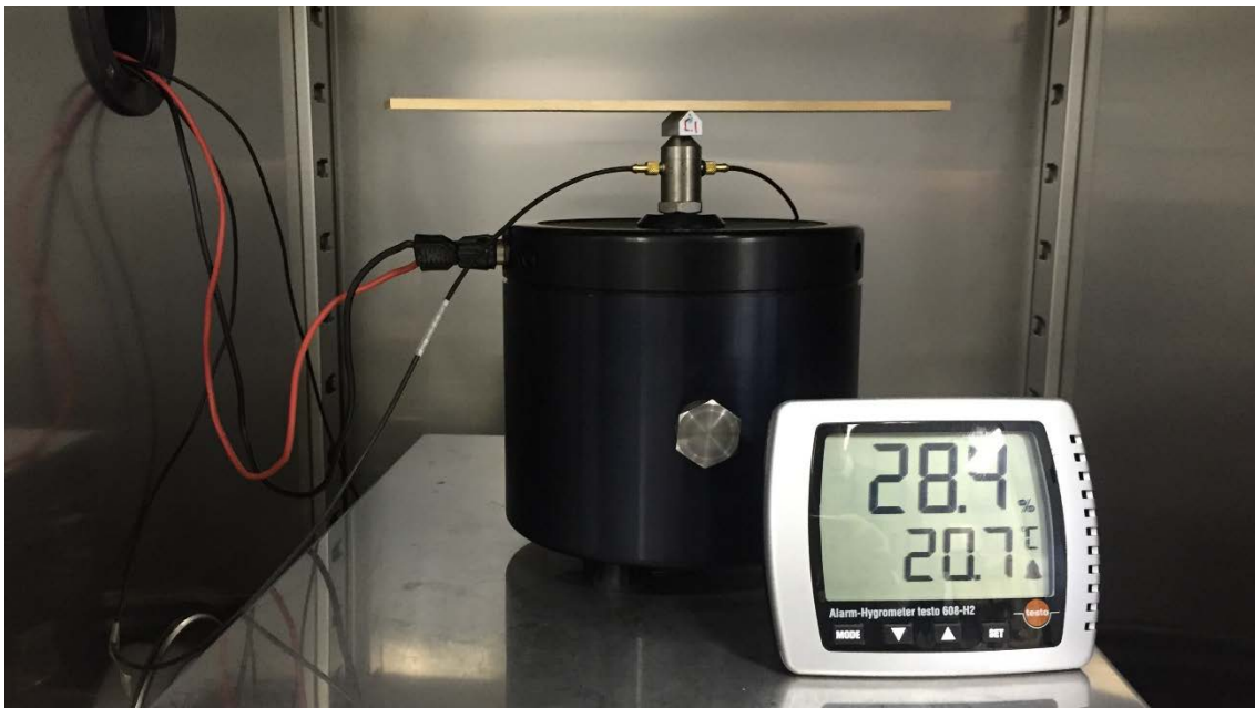
Photo.4-6. 恒温槽内の温湿度状態
