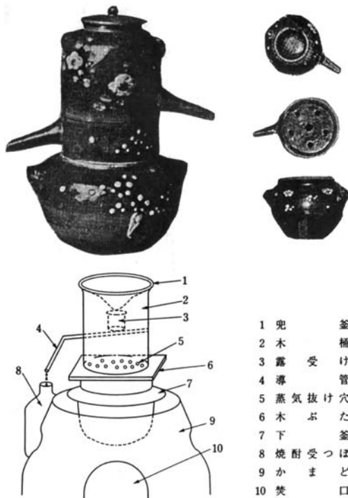
写真1及び図2 上はランビキ （かぶと 甑） 式焼酎蒸留器で、江戸時代末期に九州球磨地方の家庭で使用されたもの。下から蒸煮器、蒸留器、冷却器の三段重ねである。下の図は江戸時代の八丈島の「だんびき」で、原理はランビキとまったく同じである。
