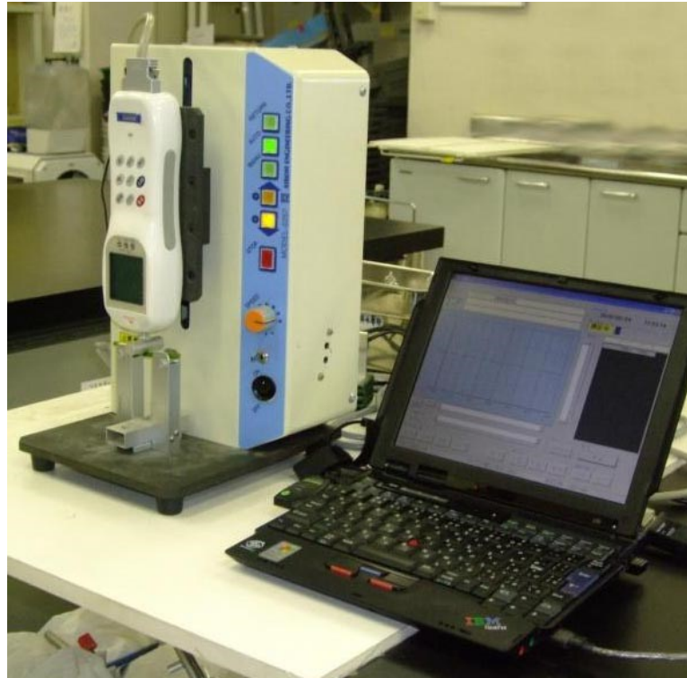
図 25 茎の曲げ強さ測定の様子
