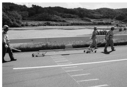
写真 2 3m プロフィロメータによる平坦性測定状況
