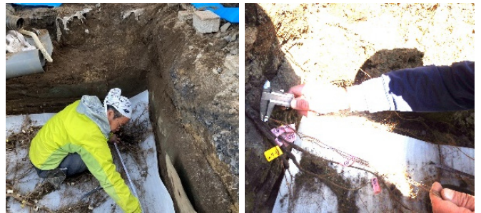
図-5 根系の伸長計測（左）直径計測・テーピング（右）
