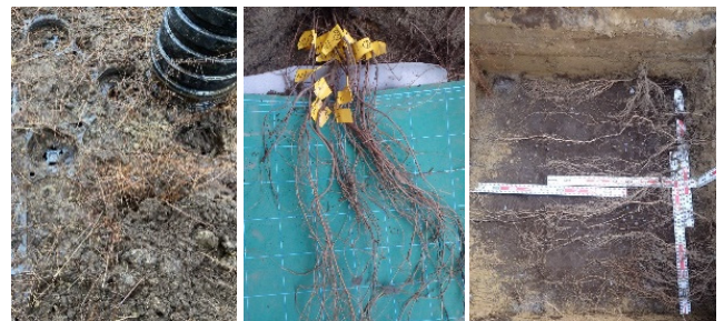
図-6 植栽基盤内の客土天端から出た「ひげ根」（左）根系伸長状況全景（中央）根系伸長状況（右）
