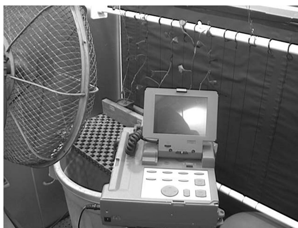
写真 3 -4℃ の実験区において送風機をかけ、冷却式赤外線サーモグラフィ装置 TH-5202 (NEC-SANEI 社製、スターリングクーラ式 HgCdTe, Long wave 8-12μm) による赤外線熱映像測定の風景
