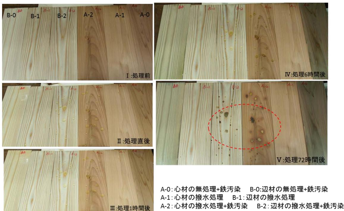
写真2.5.2 鉄汚染による変色の比較
