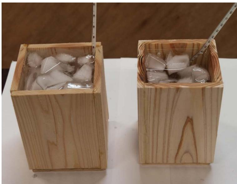
写真2.6.1 表面結露の実験様子
