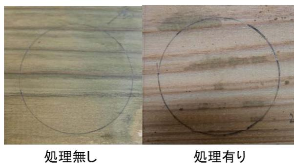
写真 2.5.1 撥水処理により鉄汚染の変色
