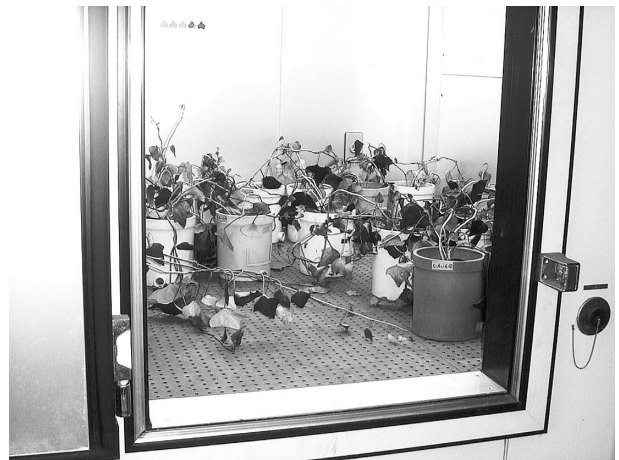
写真 1 人工環境気象室 (小糸工業社 KG-266L-s 型) にての実験風景
