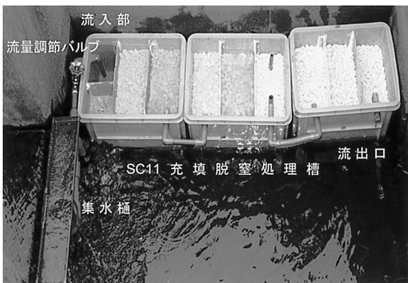
写真2 排水ピット内に設置した脱窒試験装置
