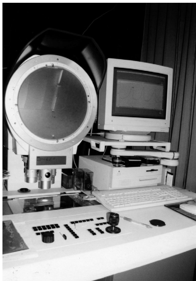
Fig. 2.5. 年輪構造解析装置 (Dendro 2003)
